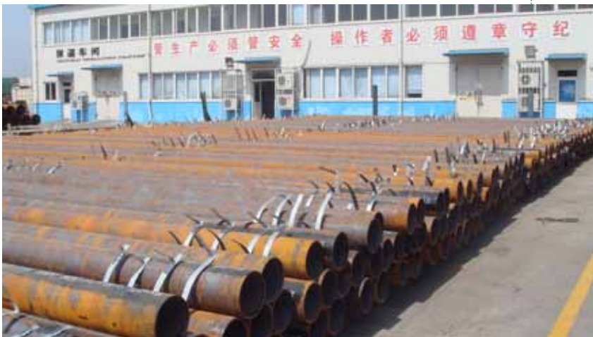
从天津大无缝购买的安哥拉海管项目的φ219无缝钢管到达中海油渤海管道涂敷厂进行3PE涂敷
