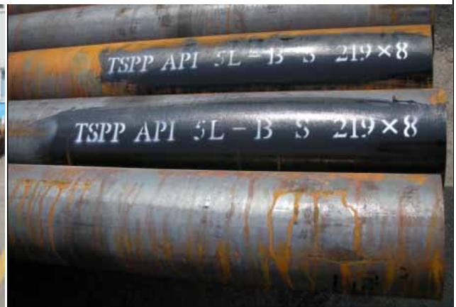
从天津大无缝采办的安哥拉海管项目的API 5L φ219无缝钢管。项目从设计到安装,全部采用国际标准。
